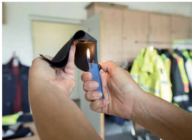
Auch für die Außentragehülle gilt: Sie muss aus Gründen des Eigenschutzes schwer entflammbar sein.
