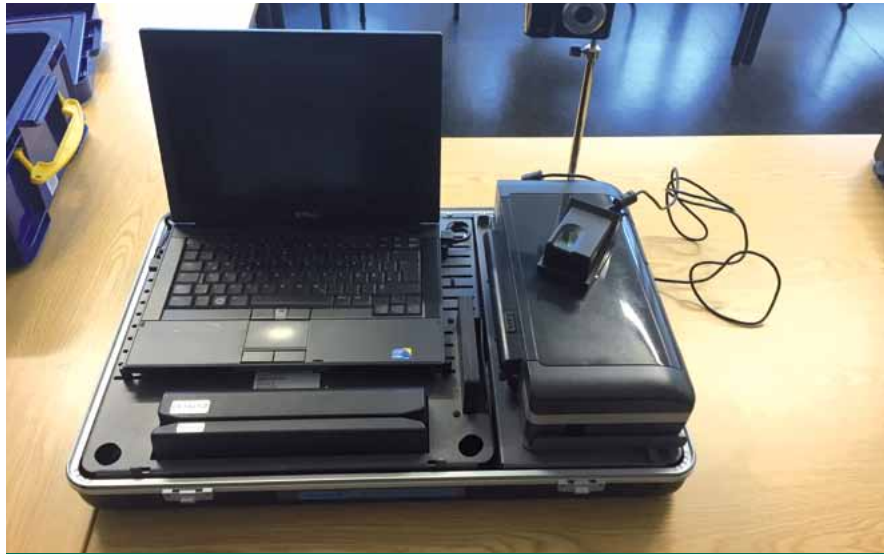
Bei der Bundespolizei wird dieser Wunderkoffer zum mobilen Arbeitsplatz inklusive Kamera, Fingerabdruckscanner und Dokumentenprüfgerät.
