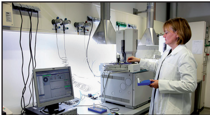
Dem Inhalt auf der Spur: Gaschromatographische Analyse von Betäubungsmitteln im LKA-Labor. Foto: Quelle – „LKA NRW, TD 51.2“
